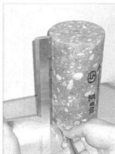
解説図 2—精密定盤と直角定規によるコア供試体の端面とコアの軸とのなす角度の測定実施例
